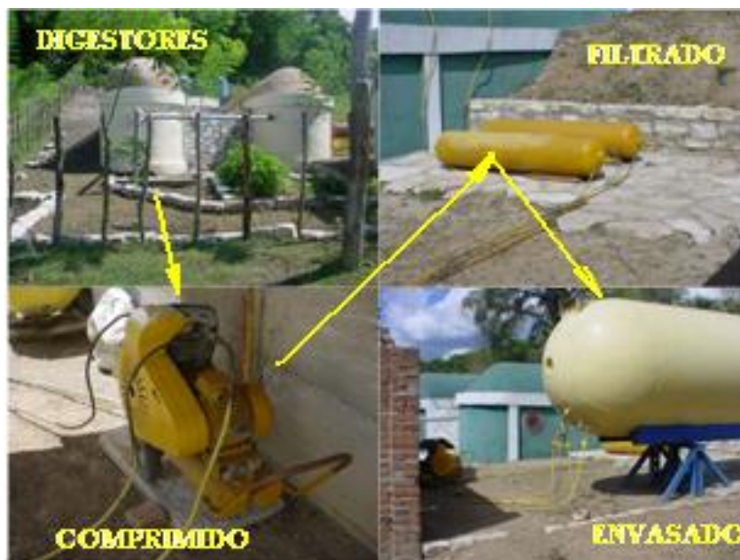
Figura 1. Componentes de la planta de biogás de Maguey
