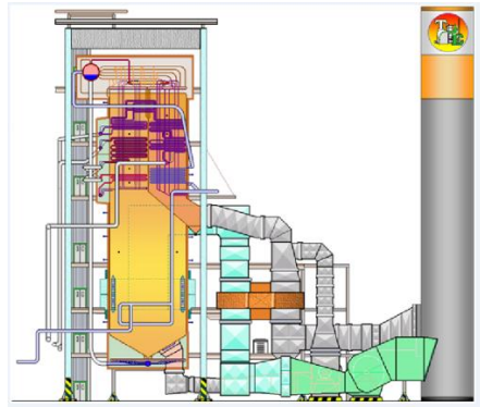
Figura 1. Generador de vapor FRANCO TOSÍ
