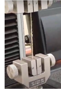
Fig. 3. Hilo sometido a prueba de resistencia mecánica.
