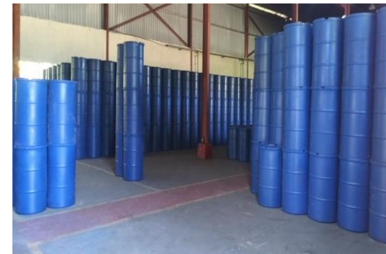
Imagen # 3: Tanques plásticos de 55 galones después del proceso de fundición por rotomoldeo
