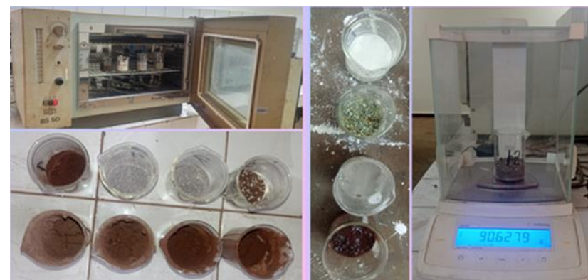
Figura 3. Proceso de pesaje y secado de las muestras. Fuente: Elaboración propia.
