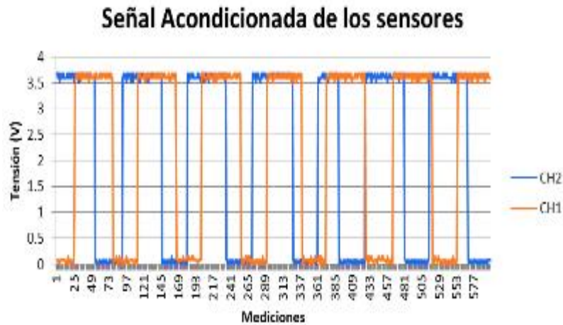
Fig. 10. Gráfica de la muestra de tensión de la señal acondicionada.
