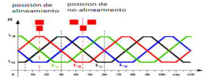
Fig. 2. Evolución de las inductancias según la posición del rotor.
