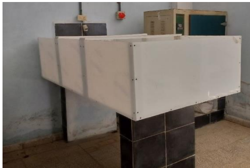
Figura 1 Canaleta de acrílico con dimensiones 2 m x 1 m x 0.50m
