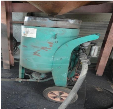
Figura 2. Máquina para el Samblasting .
