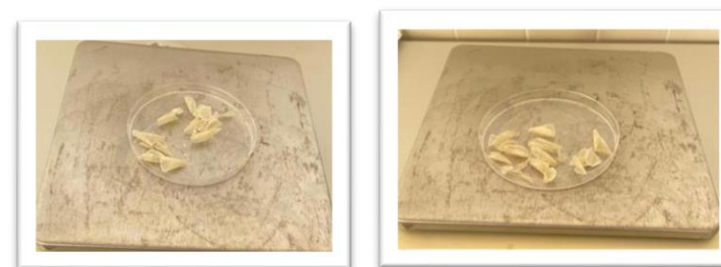
Figura 5: Parte sólida de la disolución de incrustaciones: A) HCl 1%; B) HCl al 3%. Fuente: (Autor, 2025).
