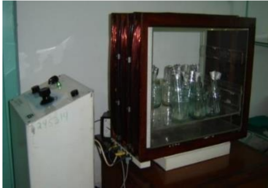
Figura 1: Estimulador Electromagnético para cultivos in vitro BioNaK-03. El dispositivo fue caracterizado con un gaussímetro, (0,01 mT de precisión; modelo FH 54, CWIEME, Alemania), que garantizó la confiabilidad del campo electromagnético, según protocolo de (Gilart et al., 2013).
