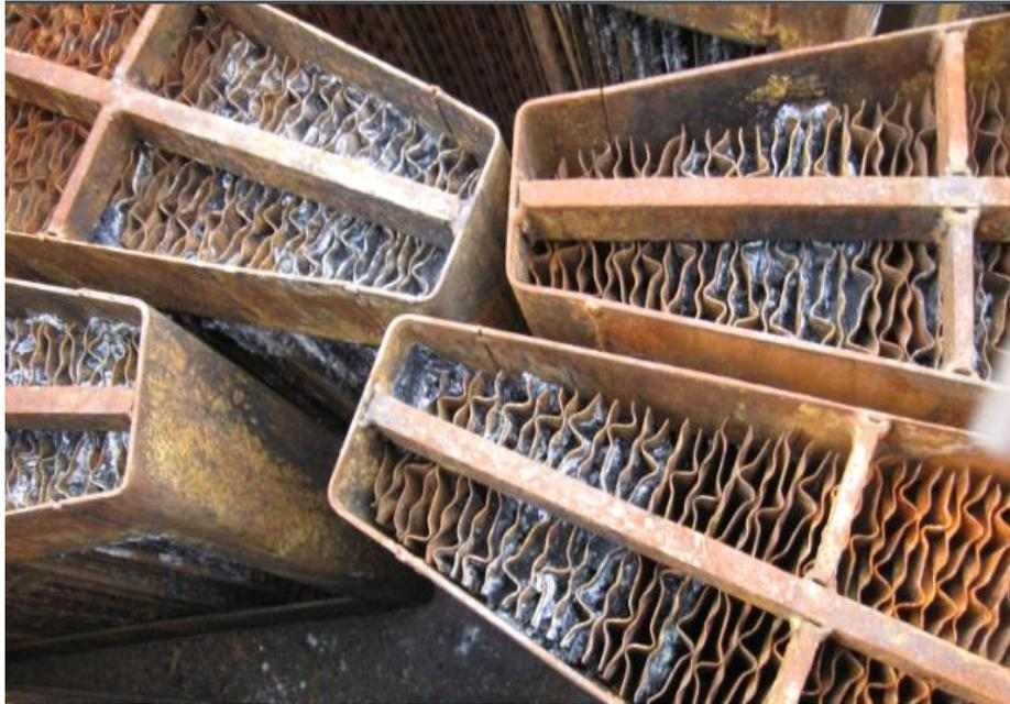
Figura 6: Proceso de corrosión en los cestos fríos de los calentadores de aire regenerativos.
