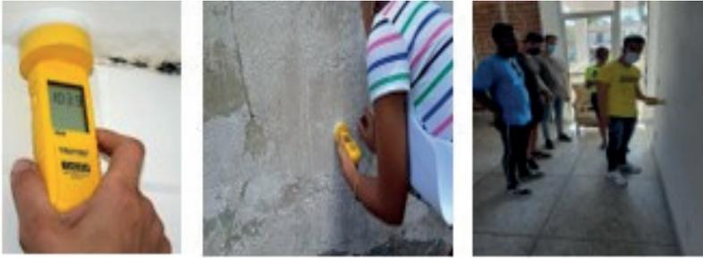
**Figura 6. Ensayo de humedad en muro con el uso del Humidímetro de profundidad. Fuente: Fotos tomadas por los autores**
