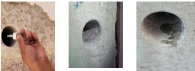
**Figura 8. Ensayo de carbonatación. Fuente: Fotos tomadas por los autores.**
