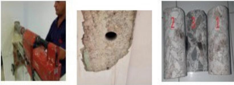
Figura 5. Ensayos de extracción de testigos en columnas. Fuente: Fotos tomadas por los autores.
