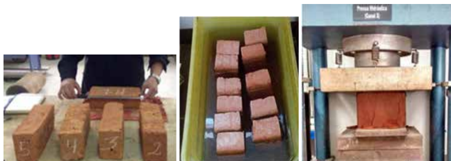
a) Determinación de las dimensiones b) Absorción de agua de ladrillos c) Determinación de la resistencia a compresión
