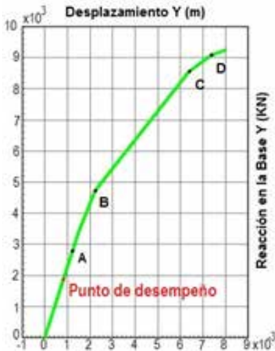
Figura 6. Representación de los niveles de daño en la curva de capacidad con respecto al eje Y
