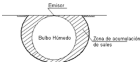
Figura No. 2. Localización de las sales en el riego por goteo
